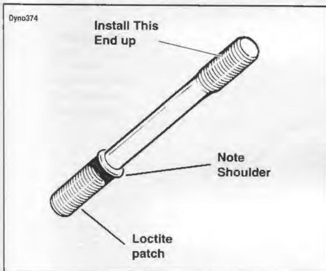
Figure 3-90. Cylinder Stud
